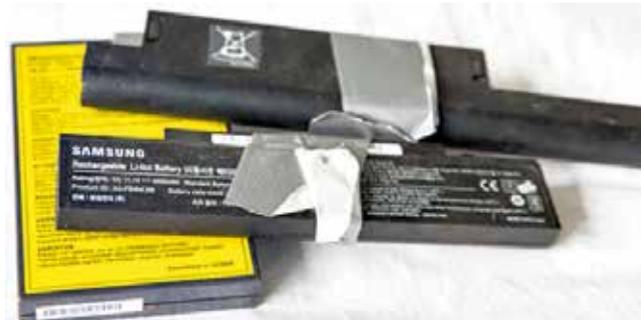
Mithilfe eines Klebebandes können ausgebaute Lithium-Ionen-Akkus leicht gesichert werden
